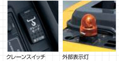
クレーンスイッチ 外部表示灯
